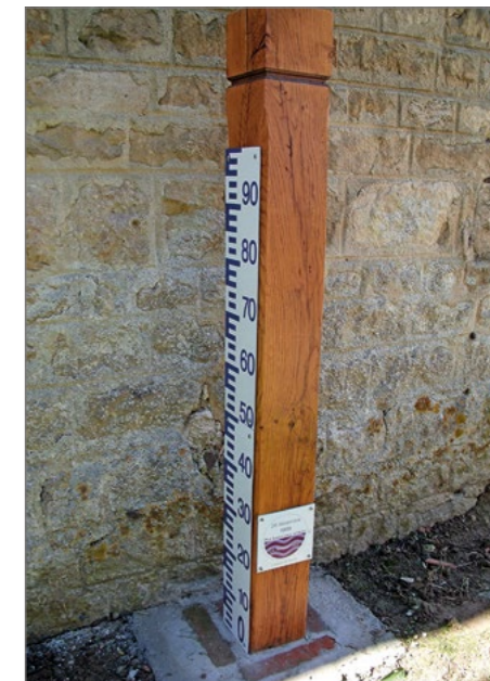
Repère de crue installé en rive de la rivière « la Sennevière » à Mortrée.
